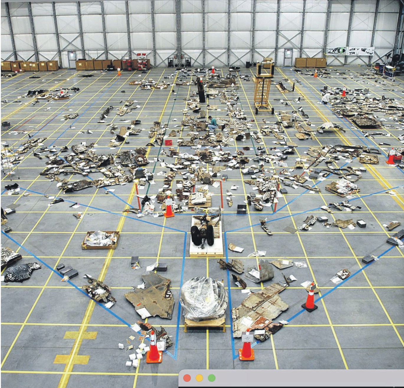
NASA_2003_Reconstitution de la navette spatiale Columbia a partir des debris retrouves.png
